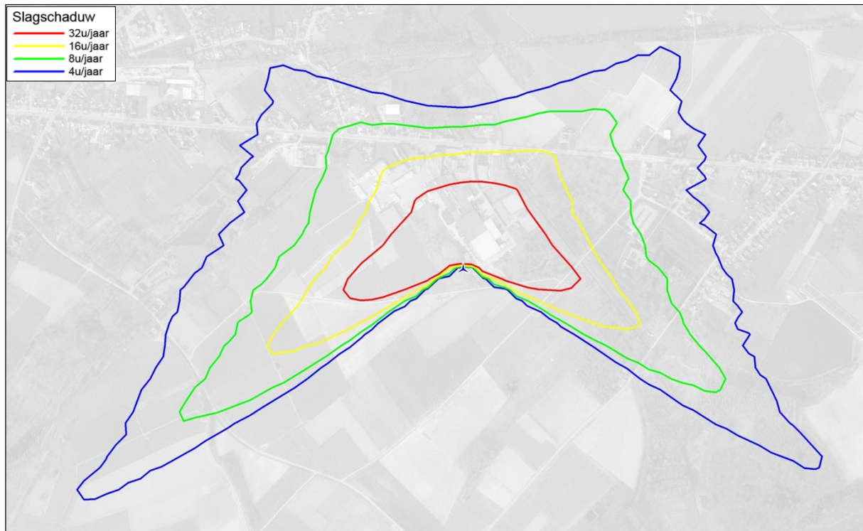
Figuur 20 : Voorbeeld slagschaduwcontouren van 1 windturbine
