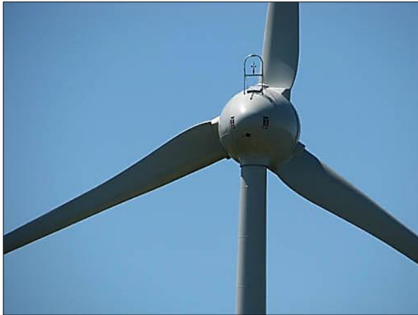
Figuur 6 : Windrichtingsmeter grootschalige windturbine horizontale as
