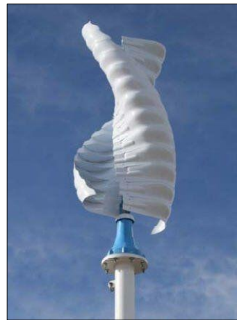
Figuur 5 : Savoniustype verticale asturbine
