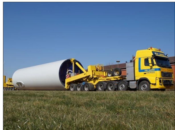
Figuur 16 : Transport onderdelen windturbine
